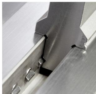
V-Lock® 은 바텀툴(다이)의 클램핑과 위치고정 기능을 향상시킵니다. 홀더 내부에 가공된 홈에 내장된 특별히 설계된 클램핑 핀으로 바텀툴(다이)을 X, Y 방향과 위치를 자동적으로 맞추고 고정시키며 클램핑합니다. 새로이 제작되는 유압식 크램핑 New Standard 크라우닝과 바텀툴 홀더는 V-Lock® 장점을 살린 클램핑 핀과 함께 공급됩니다.
