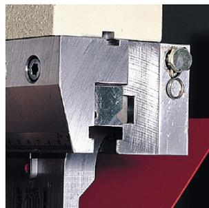
현재의 New Standard 툴 홀더 클램핑 모델은 1990년도에 처음으로 소개된 ModuFix 클램핑 시스템의 후속 모델입니다. 대체 가능품으로 WILA사의 NSCL-I-HC / 11766 모델입니다.
