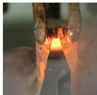
WIAL가 생산하는 거의 모든 절곡기 틀은 CNC-Deephardened® 방식으로 열처리 되었습니다. New Standard 프리미엄급 틀 홀더에도 같은 열처리 방식을 적용하였습니다. 이를 통해 모든 제품을 강력하고 수명이 긴 제품으로 생산하였습니다. 왼쪽은 WIAL의 New Standard 프리미엄 틀 홀더의 열처리 사진입니다.
