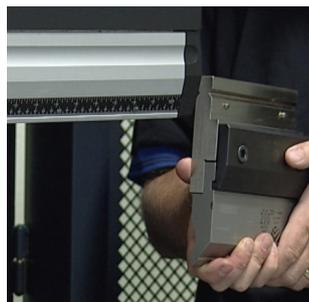
어댑터는 절곡기 상부 크램프 (핀치 홀더)와 핀치 사이에 사용합니다. 툴 시스템을 다른 형태의 툴 시스템으로 전환하기 위한 약세서라 용도로 자주 사용합니다. 이러한 어댑터는 길이 150mm와 150mm 길이의 모듈식으로 생산됩니다. 호환사용이 가능해야 하는 만큼 초정밀도가 보장되어야 합니다.
