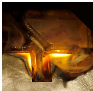
WIAL가 생산하는 거의 모든 절곡기 툴은 CNC-DeePhardened® 방식으로 열처리 되었습니다. New Standard 프리미엄급 툴 홀더에도 같은 열처리 방식을 적용하였습니다. 이를 통해 모든 제품을 강력하고 수명이 긴 제품으로 생산하였습니다. 왼쪽은 WIAL의 New Standard 프리미엄 툴 홀더의 열처리 사진입니다.
