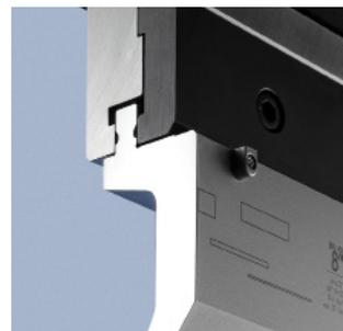
WILA는 북미형 툴에 있어서도 UPB 개념의 프레임속에 수동 클램핑 시스템을 적용 하였습니다. 클램핑 플레이트로 클램핑 상태가 지속 되도록한 기계적 구조입니다. 펀치는 클램핑 플레이트를 수동으로 조임으로서 클램핑됩니다. 단 펀치는 자동적으로 위치를 찾아가지는 못합니다. 이 기계적인 미케니칼 시스템은 표준 및 WILA가 Safety-Click® 포함하여 재설계한 북미형 펀치 클램핑에 적용됩니다.
